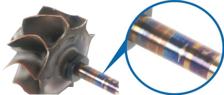
Şəkil 12. İtələyici yastıqda hədsiz aşınma
