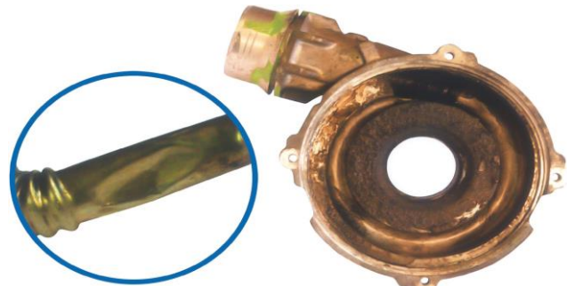
şəkil 13. Yağ qaytarma borusunun zədələnməsi
