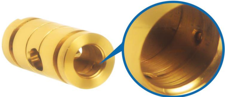
Şəkil 3. Uzun zalotnik vtulkasında cızıqlar
