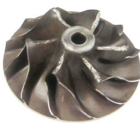
şəkil 4. Kompresor çarxının induktorunun zədələnməsi
