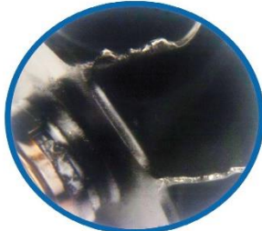
şəkil 5. Türbin çarxının indukleiyasında qüsür
