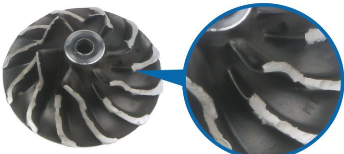
Şəkil 8. Kompresor çarxının sürtülməsi
